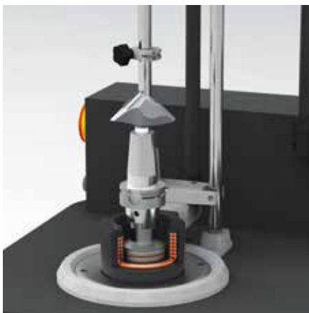
Bild1: Einsetzen Werkzeugträger Image1: Inserting tool adapters
