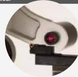
Telecamera HD con obiettivi telecentrici. Campo di visione di 7x7 mm e 40x ingrandimenti. Permette sia la misurazione utensile con risoluzione 0,001mm che l'ispezione utensile in modalità Real View.
