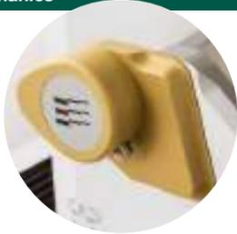
LA MOVIMENTAZIONE RAPIDA DEGLI ASSI avviene con una mano sola tramite un singolo pulsante ben posizionato sull'impugnatura studiata per la massima ergonomia. Il movimento degli assi risulta fluido e senza sforzo grazie ad un perfetto bilanciamento dei pesi.
