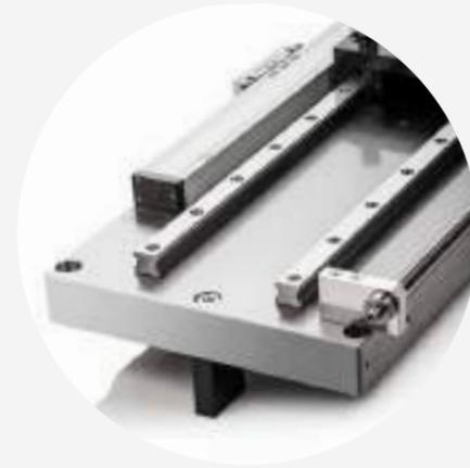
**Piastra in ACCIAIO stabilizzato** rettificato con planarità  $\pm 2\mu$ . Doppia guida di scorrimento in classe di precisione SP con pattini precaricati a ricircolo di sfere.
