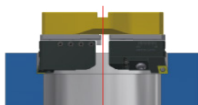
Twin edge boring
