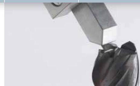
Il P368M è un presetter molto robusto nato per rendere semplicissima ed accurata la misurazione dell'altezza utensile.
